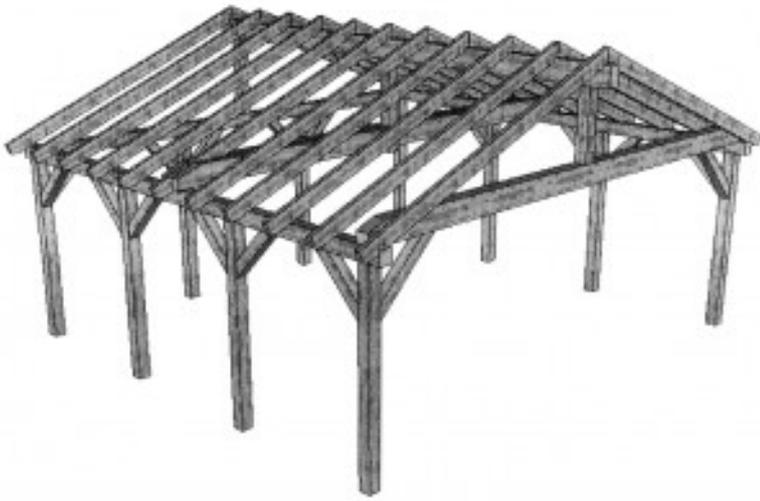
Ja, so sieht das Grundgerüst aus. Bis auf die Sparren ist alles aus Leimbindern gefertigt. Das hat einfach den Vorteil, das sich fast nichts mehr verzieht oder reißt. Die Breite beträgt 6,50 Meter und die Tiefe 7 Meter, die Durchfahrtshöhe liegt bei 2,47 Meter. Das Dach hat 22 Grad Neigung.
